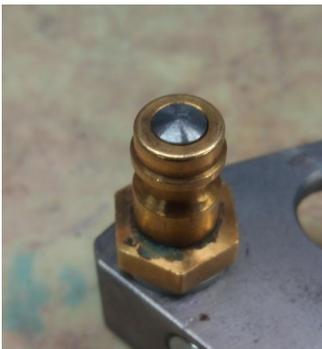
Geniale Schnellkupplung, sobald die Schnellkupplung getrennt wird ist die Bohrung verschlossen um ein Eindringen von feinen Spänen und Schmutz zu vermeiden. Somit können bei Mehrfach-Revolvern mehrere Kassetten im Arbeitsraum bleiben. Generell wird ein verstopfen der Düsen vermieden.
